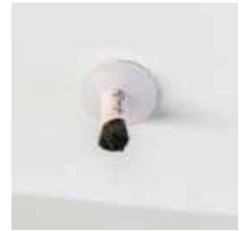
Metallborsten im Lampengehäuse zur Ionisierung.
