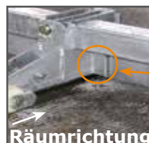
Räumklappenanschlag: kein Bodenkontakt
