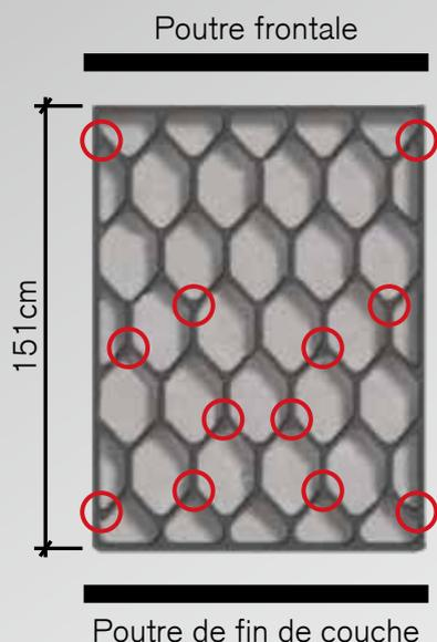
Les nids d'abeille lit de sable doivent être fixés aux emplacements marqués. Il est important que le remplissage ne s'effectue qu'après la fixation, afin que le mélange chaux-paille ne glisse pas sous le tapis et le soulève.
