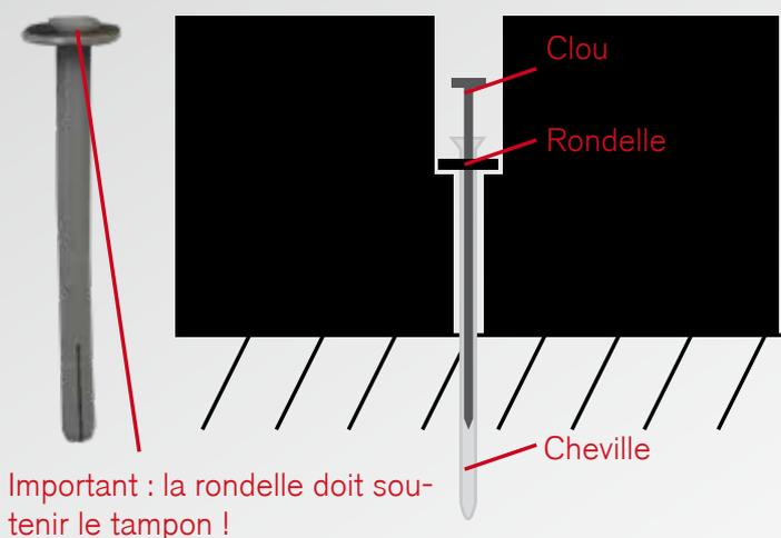
Percez directement dans le béton à travers le caoutchouc avec une mèche à béton de 8 mm aux points de fixation indiqués. Passez le tampon à travers la rondelle (pour que le tampon ne puisse pas chuter), puis placez dans le trou. Plantez ensuite le clou dans le tampon.
