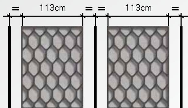
Les nids d'abeille lit de sable doivent être centrés entre les arceaux. Avant la pose, il faut veiller à la planéité du sol.
