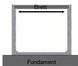
Während dem Aufschütten sollte der Kanal z. B. mit einem Brett stabilisiert werden, um dem seitlichen Druck entgegenzuwirken.
