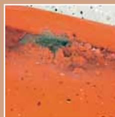
Les cloques détruisent le revêtement. Aucune formation de cloques avec le barrage d'humidité **Vencomat**.
