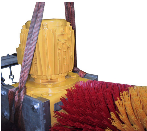
Illustration 3: fixation de la sangle de levage
