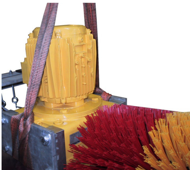
Abbildung 3: Befestigung des Hebegurtes
